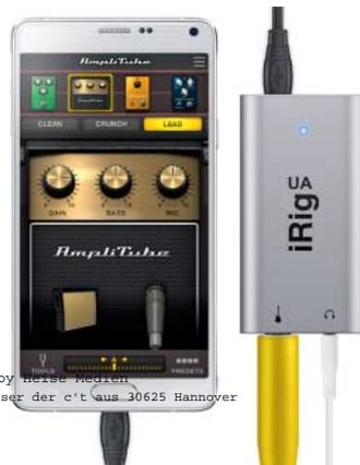
iRig UA und AmpliTube machen aus Android-Smartphones mobile Gitarrenverstärker.
